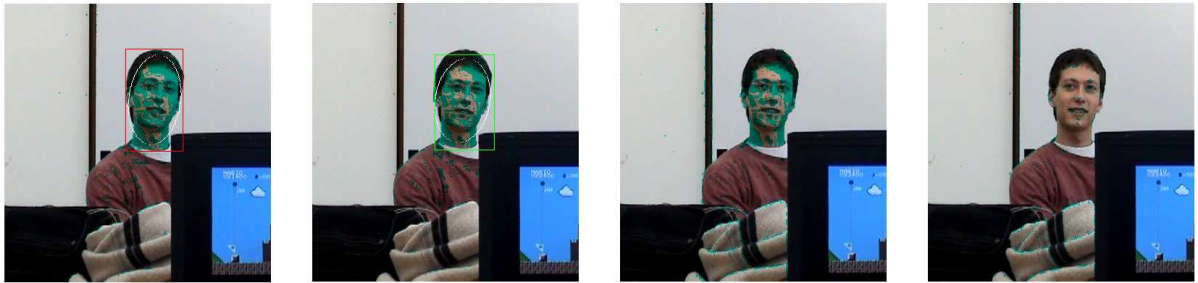
FIG. 4.7 – Perte d'un visage suite à la non-détection de pixels de la couleur de la peau : le système commence par suivre le visage grâce aux histogrammes de couleurs avant de le perdre, il est alors inclus dans l'arrière-plan (les pixels verts sont ceux détectés comme étant de la couleur de la peau et en superposition sur l'arrière-plan).
