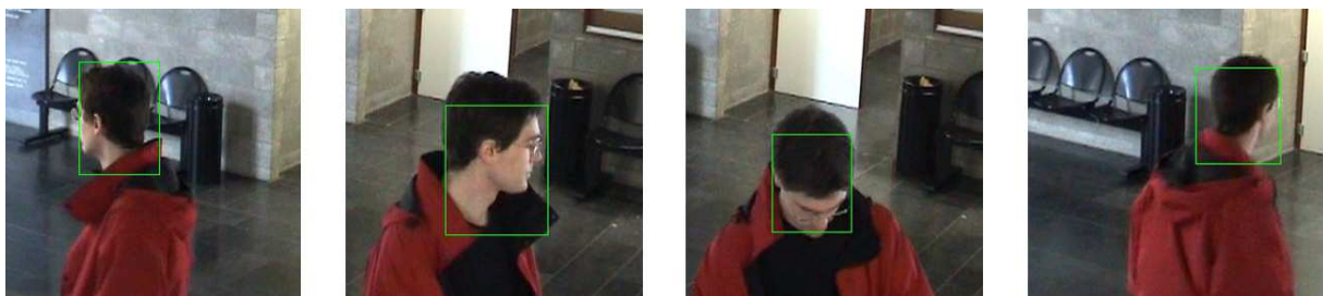
FIG. 4.3 – Suivi correct par histogrammes de couleurs d'un visage qui n'est plus face à la caméra.
