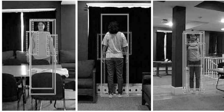
FIG. 2.28 – Illustration de la robustesse du système décrit dans [32] face à des personnes dont certaines parties du corps sont occultées (images de gauche et de droite) ou dont certaines parties du corps ne sont pas détectées parce qu’elles ressortent trop peu de l’arrière-plan (image du milieu).
