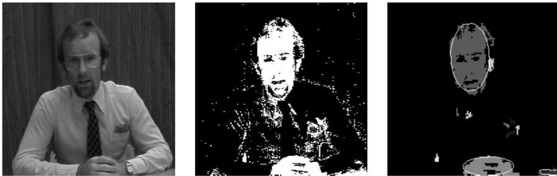
FIG. 2.9 – Détection des pixels de peau et génération des meilleures ellipses pour les zones connexes de taille suffisante.
