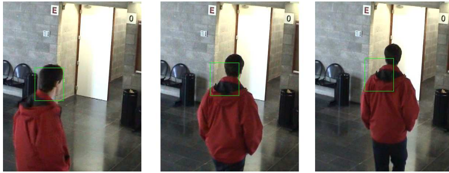
FIG. 4.4 – Baisse de l'exactitude du suivi par histogrammes lorsque la taille du visage suivi varie.
