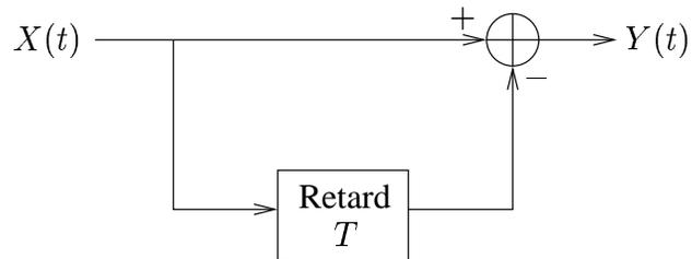
où  $Y(t)$  est le signal à la sortie du circuit.
